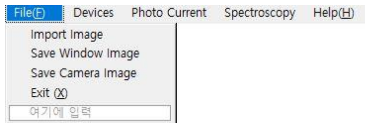
그림 2 File 메뉴에 있는 "Save Window Image" 또는 "Save Camera Image" 메뉴를 선택하여 저장
